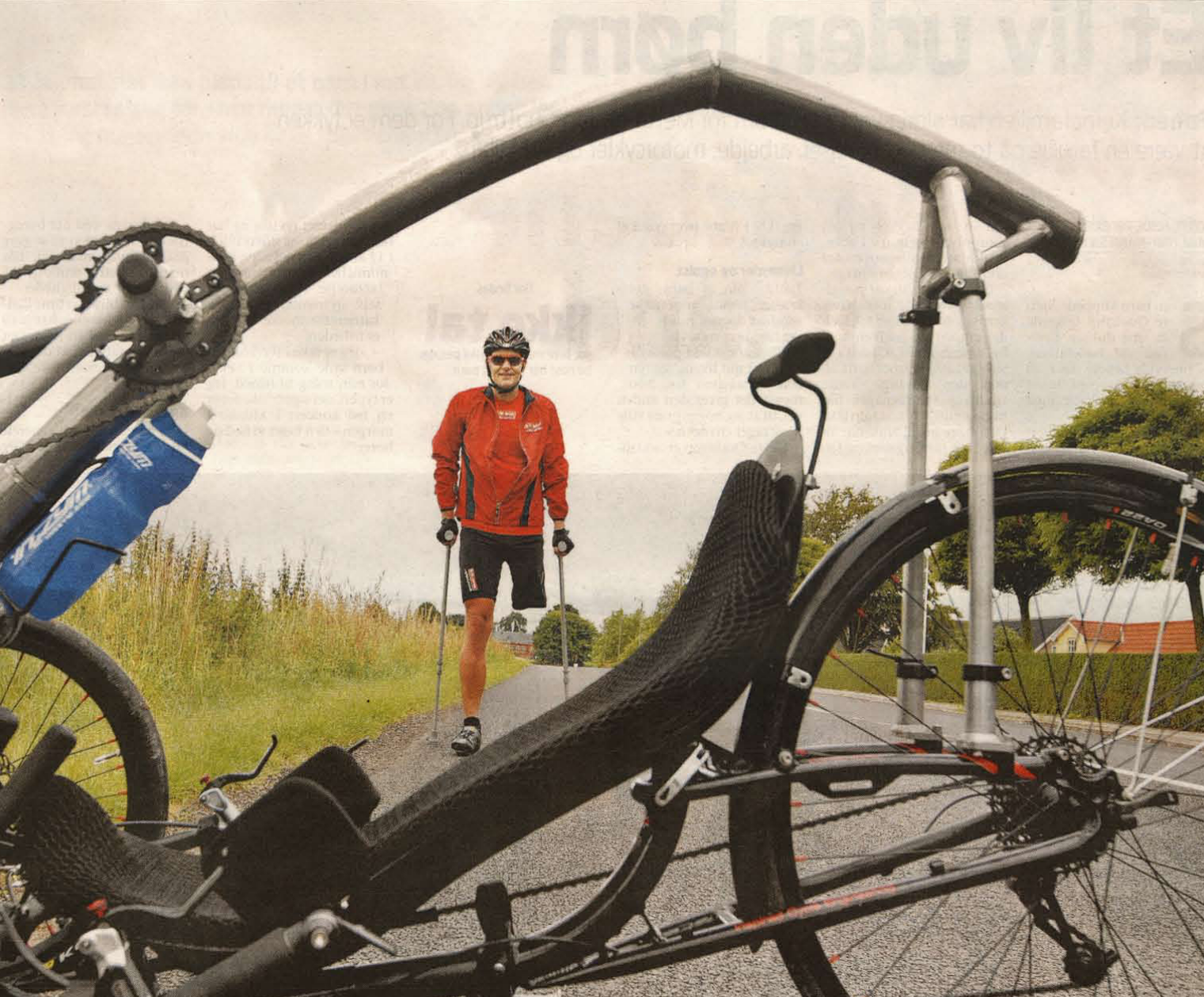
Gert Rune har selv udviklet sin cykel, der er bygget sammen af en trehjulet racerliggcykel samt kranken fra en hånddrevne cykel. Inden googling har overbevist den 41-årige jernmandsambition om, at hans køretøj er verdens første hånd- og foddrevne racercykel. Foto: Ole Lind
